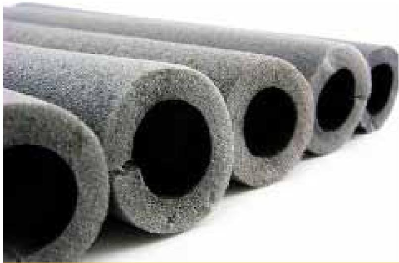
bau sollte man also gleich darauf achten. Die Weichschaum-Schläuche werden dann mit einem speziellen Kleber oder einer Bandage befestigt. Möchte man seine Rohre nachträglich isolieren, ist auch das meist kein Problem. Dann werden die erwähnten Schläuche zunächst an der Längsseite mit einem Cuttermesser aufgeschnitten. Danach werden die Schläuche um die Rohre gelegt. Anschließend wird der Schlitz mit Spezialklebeband gut zugeklebt.
