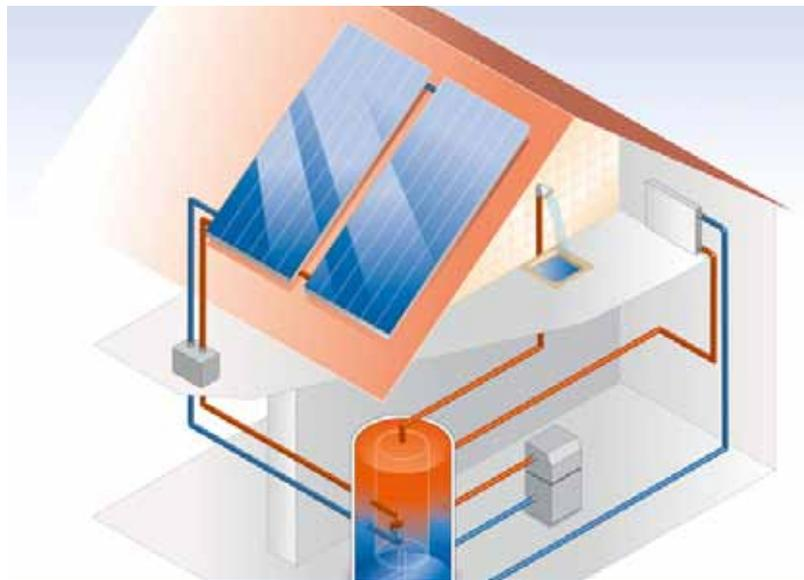
gie gewonnene Wärme in diesem Speicher nicht ausreichen, wird das Wasser über einen zweiten Wärmetauscher, der an den Heizkessel angeschlossen ist, auf die richtige Temperatur erhitzt. Ein Ventil lässt überschüssigen Druck aus dem Speicher ab, sollte die Hitze zu groß werden.
